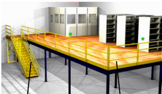
Escalier : Pente modérée Présence de rampes Marches conformes
